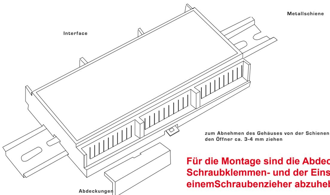
**Für die Montage sind die Abdeckungen für die Schraubklemmen- und der Einstelleisten mit einem Schraubenzieher abzuhebeln!!**
