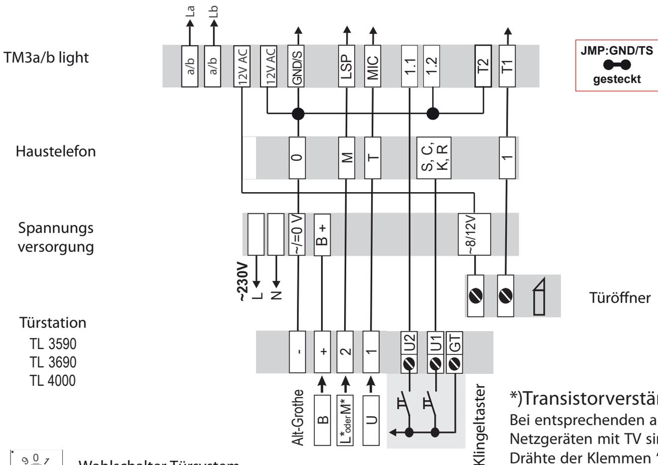
\*) Transistorverstärkung: Bei entsprechenden alten Netzgeräten mit TV sind die Drähte der Klemmen "L" und "M" miteinander zu verbinden!
