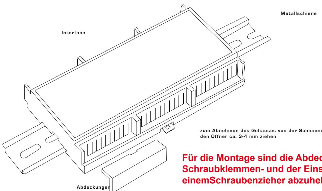
**Für die Montage sind die Abdeckungen für die Schraubklemmen- und der Einstelleisten mit einem Schraubenzieher abzuhebeln!!**
